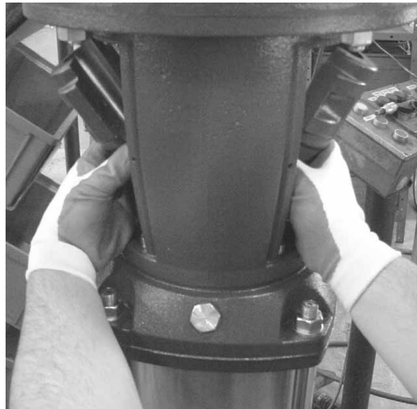
Mitnehmerstift und Kupplungshälften einbauen
