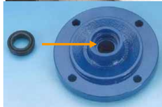
Austausch des stationären Rings der Gleitringdichtung
